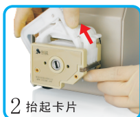
2 抬起卡片 依箭头方向抬起卡片至拿出卡片。
