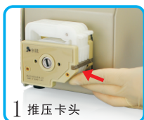
1 推压卡头 依箭头方向推压卡头使其脱开方杠。
